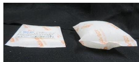
ミニバッグ 吸水後 吸水前 (7 g) 吸水後 (280 g)
