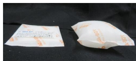
水道水吸水 吸水前(7g) 吸水後(280g)
